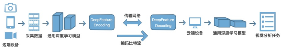
图 3-7 深度学习模型中间层特征传输流程
